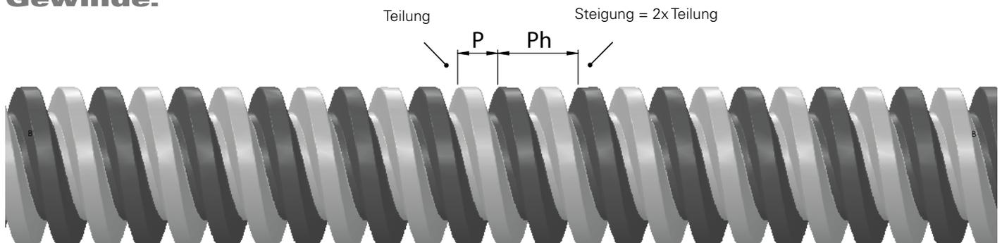
Mehrgängige Gewinde haben das gleiche Profil wie eingängige Gewinde mit der Steigung  $P_h = \text{Teilung} \cdot P$ .
