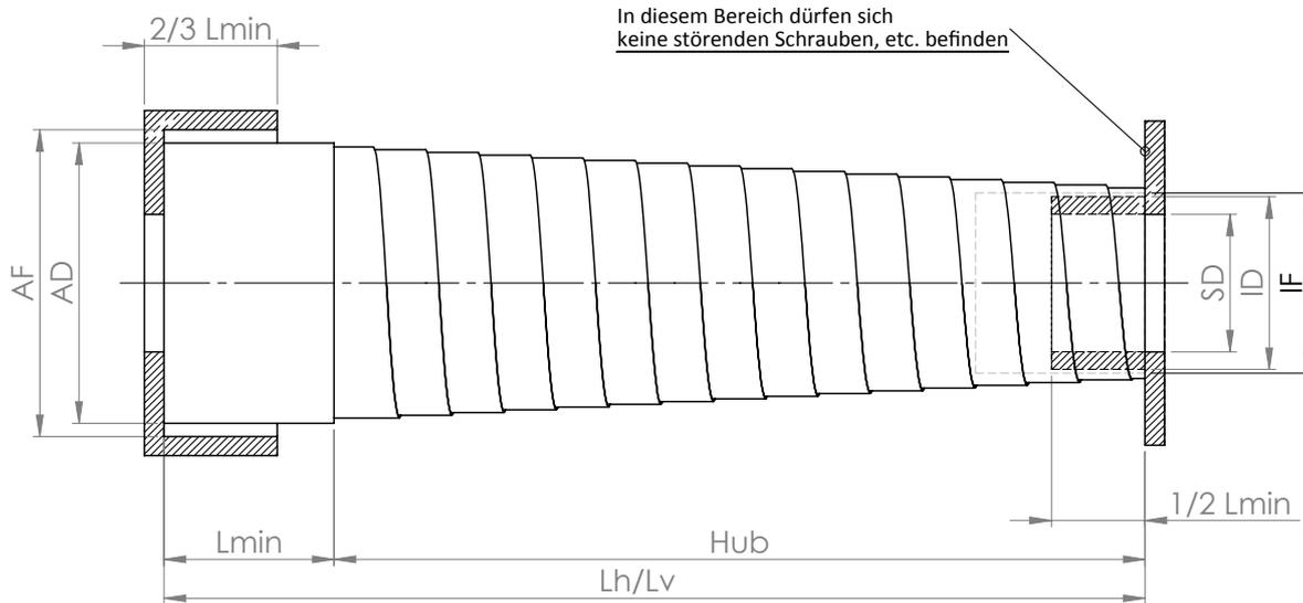
SD = Maximaler Außendurchmesser/ Spindeldurchmesser
