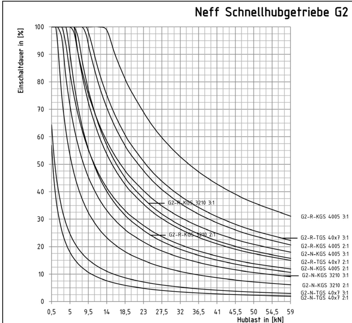
Um die Einschaltzeit  $ED_{n'}$  für andere Drehzahlen zu ermitteln wird die Einschaltzeit in [%] mit dem Drehzahlfaktor  $fn_{neff}$  multipliziert:
