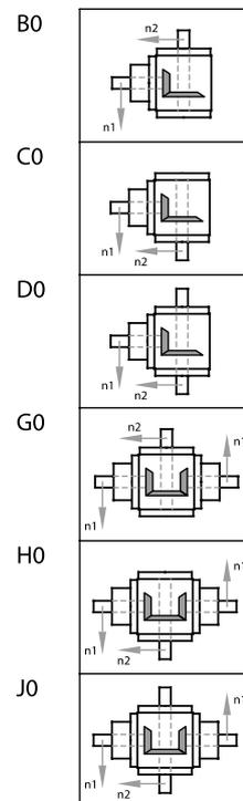
Achtung: Standardbefestigungsgewinde im Gehäuse nur an den Seiten 1, 2 & 4.
