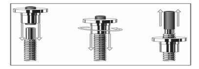
Important : Ne retirer le manchon de montage que si l'écrou est entièrement monté sur la vis.
